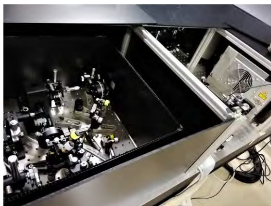
図2 自作のハイパーラマン分光装置
