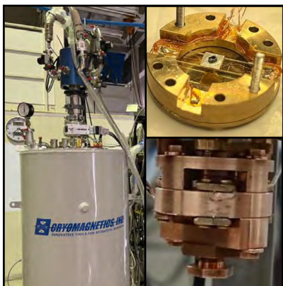
（左）ベクトルマグネットと希釈冷凍機。0.1 K 以下まで磁場方向の精密制御が可能。（右上）比熱や磁気熱量効果を測定するための自作の高感度熱量計。（右下）自作のサブピコメートル膨張計。
