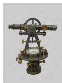
トランシット(測量機器)
