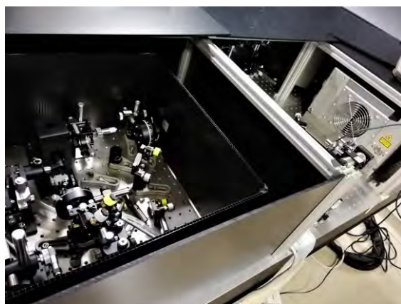
図2 自作のハイパーラマン分光装置
